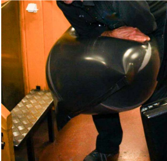
Operatören pressar ihop en uppblåst plastpåse för att testa svetsfogen.
