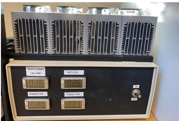
Bild 8. SHT's egen demonstrator visar att arbetstemperaturen kan sänkas 4 grader för kylning av 24Ws LED-lampa jämfört med kommersiellt tillgängliga material.
