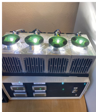
Bild 8. SHT's egen demonstrator visar att arbetstemperaturen kan sänkas 4 grader för kylning av 24Ws LED-lampa jämfört med kommersiellt tillgängliga material.
