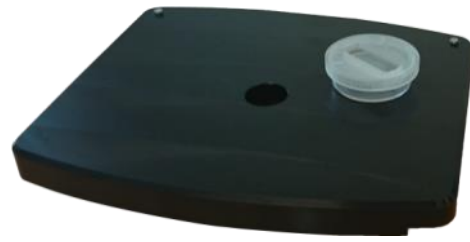
Bilden visar en prototyp av Bolagets odlingskärl stående på HoloMonitor M4:ans löstagbara bord. Kärlet är 35 mm i diameter.
