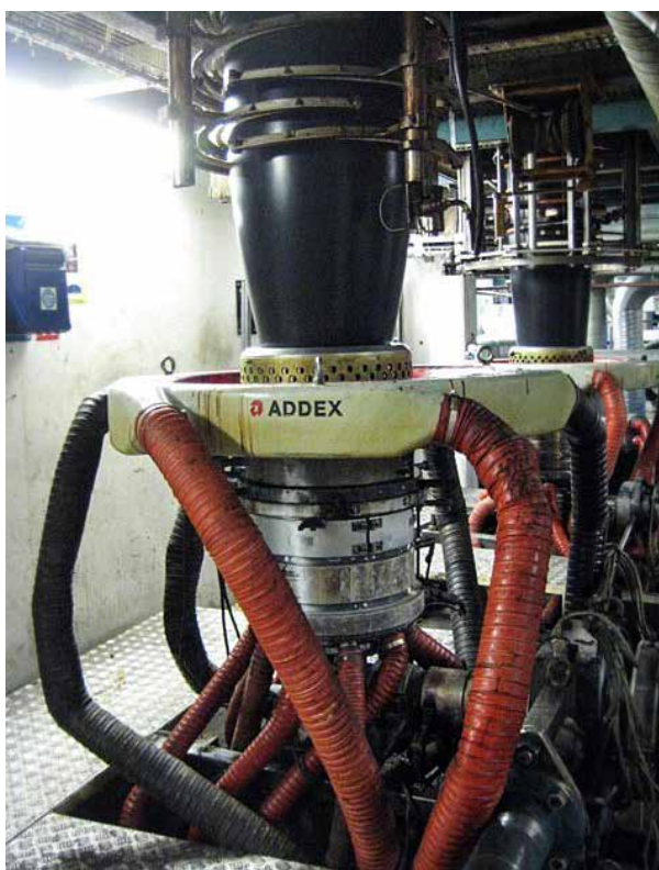
Den smälta plasten pressas genom ett munstycke och blåses upp likt en ballong till önskad diameter samtidigt som den avkyls. Här tillverknig av svarta sopsäckar.
