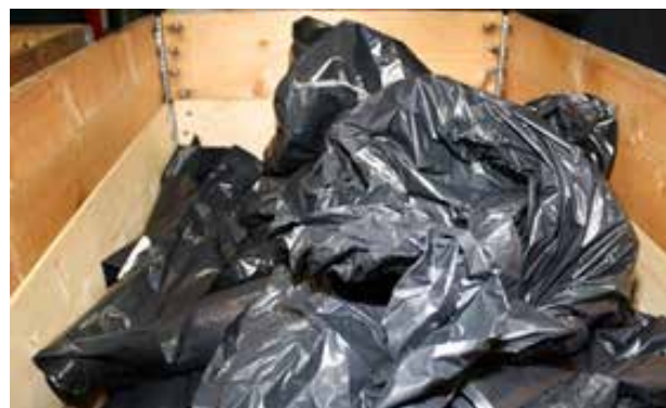
Plastpåsar av undermålig kvalitet samlas upp och regranuleras.
