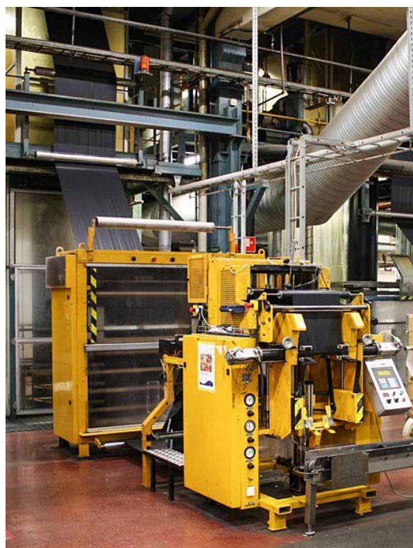
Plastfilmen svetsas och perforeras till påsar och rullas upp på rulle
